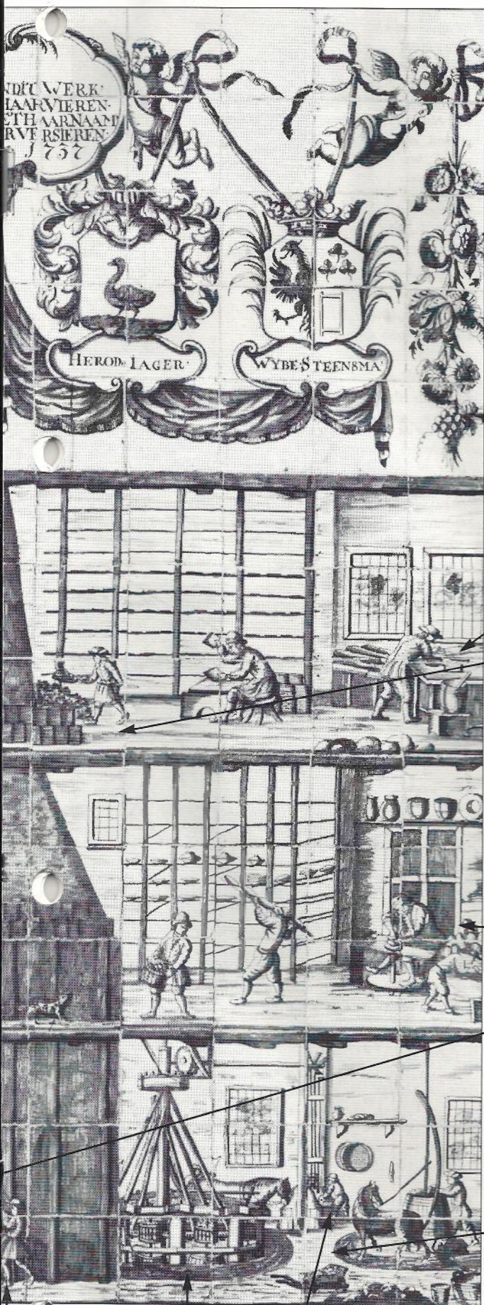
Zgn. tredmolen Stampmechaniek om klei te wassen en te kneden
